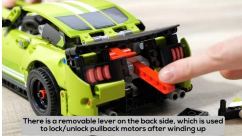
Şekil 11: Çek-bırak mekanizmasının çıkarılıp takılabilen kolu (kırmızı parça)
